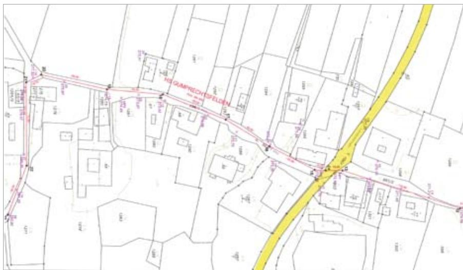
steigerungsanlage erforderlich. Insgesamt sind 1.160 m Transport- und Versorgungsleitungen mit einem Nenndruck von 10 bar in einer Tiefe von 1,60 m sowie 5 Hydranten zu errichten. Der maximale Wasserverbrauch eines zukünftig verbrauchsreichen Tages wird 21,6 m<sup>3</sup> betragen. Die Schmutzwasserkanäle werden vom derzeitigen Geländeniveau ausgehend in einer Tiefe von 1,80 bis 2,80 m verlegt.
